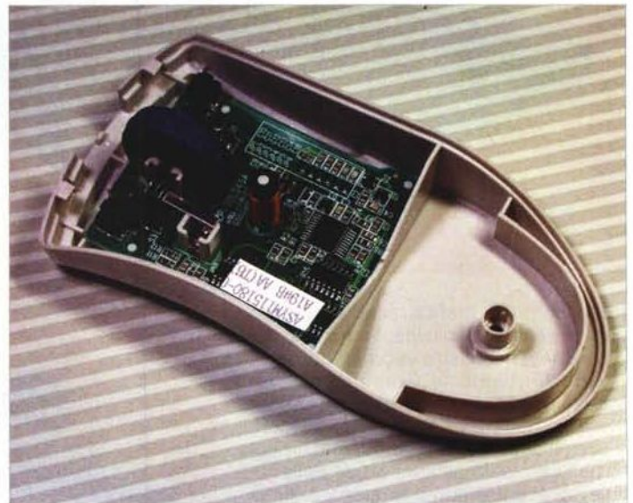
Particolare della bobina all'interno del mouse Graphire: è utilizzata sia per ricevere l'alimentazione dalla tavoletta, sia per comunicare la posizione al sistema.
